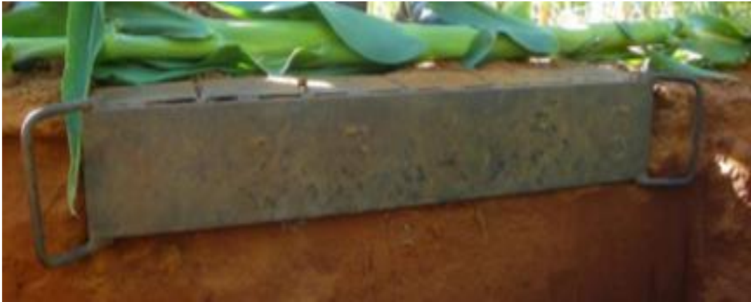
Figuur 2: Staalplaat om grondmonsters te neem. (Foto verskaf deur Jan du Toit Landboukundige van Omnia)
